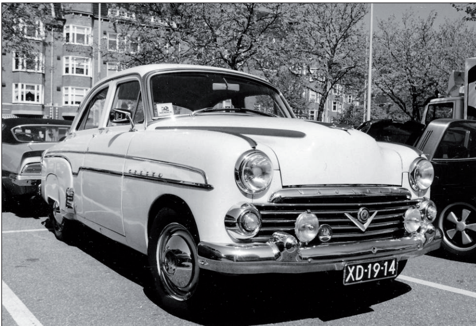
Zescilinder Vauxhall Cresta E-type. Topsnelheid circa 132 km/u bij een verbruik van 12 liter per 100 km. Gebouwd van 1954 tot 1957 in een oplage van 166.504 stuks. (foto auteur).
