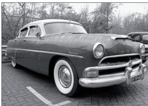
1954 Hudson Hornet vierdeurs sedan met een 'Instant Action' 5047 cc zescilindermotor van 160 pk bij 4000 omw/min. Topsnelheid 160 km/u bij een verbruik van 20 liter per 100 km. Uitgevoerd met Twin-H Power (dubbele carburateur) was het motorvermogen 170 pk. (foto auteur).
